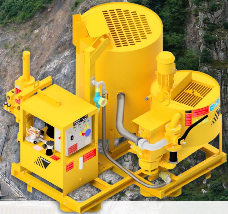
La combinaison des composants standard éprouvés de Häny, tels que le turbo malaxeur, l'agitateur et la pompe d'injection, permet d'obtenir une centrale d'injection extrêmement compacte. Cette configuration convient à une grande variété d'applications telles que l'ancrage, le tube à manchettes et les injections de remplissage. Les centrales sont également disponibles en version automatique et semi automatique pour garantir une productivité et une qualité supérieures.
