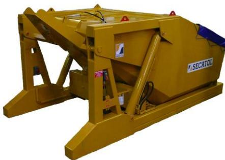
**Utilisation :** Cette benne d'attente, dite « TAMPON », sert à stocker le béton frais ou sec provenant de la centrale par camions mélangeurs (Truck-Mixer) ou camions-benne. Elle est souvent utilisée dans le domaine de la **projection par voie sèche**.
