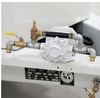
Le graisseur automatique en option assure la lubrification nécessaire et réduit la main-d'œuvre d'entretien tout en prolongeant la durée de vie des composants.
