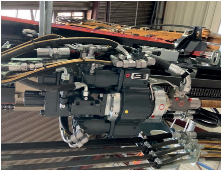
Eurodrill RH 4 X en construction modulaire
